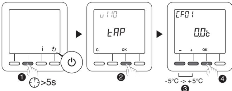
**Le thermostat doit être en mode Arrêt.**
