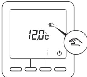
Sollte bei einer externen Programmunterbrechung das Symbol
