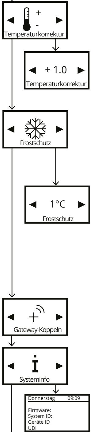
Mit diesem Menüpunkt kann eine Korrektur der Messstemperatur erfolgen. Sollte die vom eingebauten Fühler des AeroFlow®-Heizkörper gemessene Raumtemperatur von der tatsächlichen Raumtemperatur abweichen, lässt sich ein Ausgleichswert einstellen.
