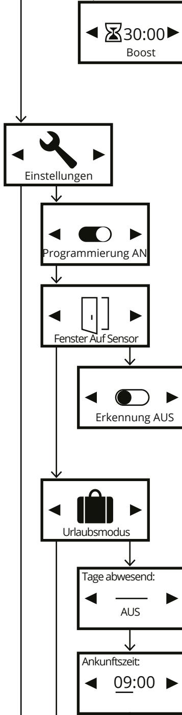
De standaardwaarde is 30 minuten. Deze tellen onmiddellijk terug. U hoeft niet op een knop te drukken. Gebruik de pijltoetsen om in 5 minuten in te stellen hoeveel minuten de AeroFlow®-radiator doorgaand zal verwarmen. Druk op de knop OK om de boostfunctie te stoppen.
